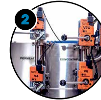
2 Valves SS 3A motorisées
